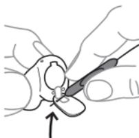
Ouvrez le couvercle du logement de la pile et tournez l'aide auditive de manière à ce que le couvercle soit orienté vers le bas (voir l'illustration).
