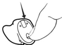
Utilisez l'ergot pour pousser le couvercle du logement de la pile vers le bas et ouvrir le couvercle.
