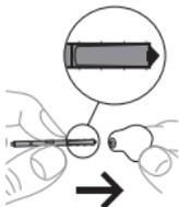
Insérez le crochet de retrait dans le pare-cérumen usagé.
