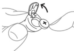
Placez maintenant la pile dans le logement de la pile comme indiqué. Fermez le couvercle du logement de la pile. Si celui-ci ne se ferme pas facilement, alors la pile n'est pas placée correctement.
