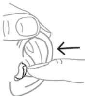
Fermez complètement le couvercle du logement de la pile. Prenez l'aide auditive entre le pouce et l'index et insérez-la avec précaution dans votre oreille jusqu'à ce que vous sentiez une résistance.
